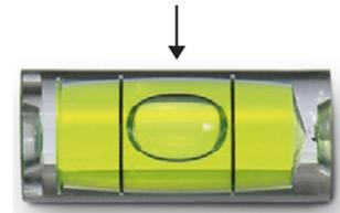
la bulle d'air du niveau à bulle doit se trouver entre les deux lignes
